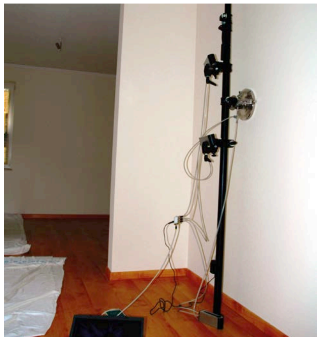
Fig. 15 Mesure de l'émission d'une peinture in situ .
